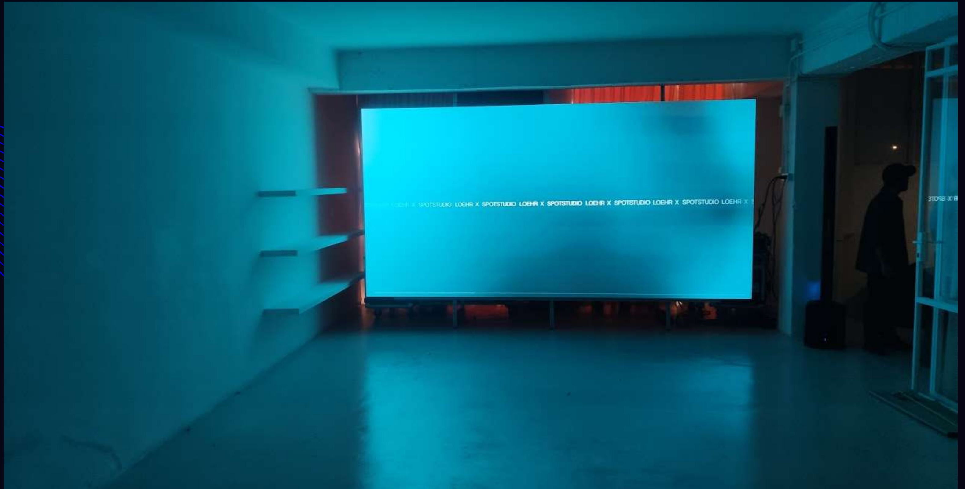
Pantalla de led con estructura trasera y autosoportada Módulos de 50x50
